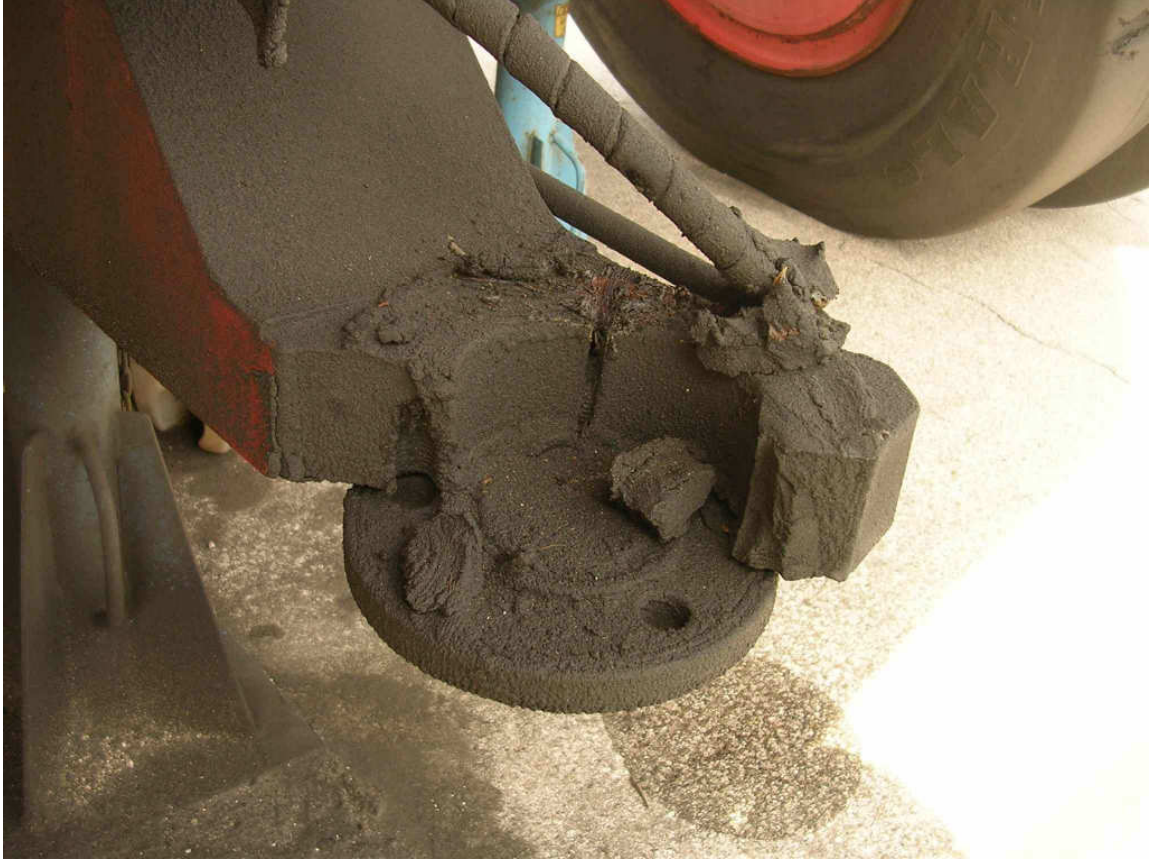
FOTO 5 – ROTTURA SUPPORTO INFERIORE SX – N. 611
