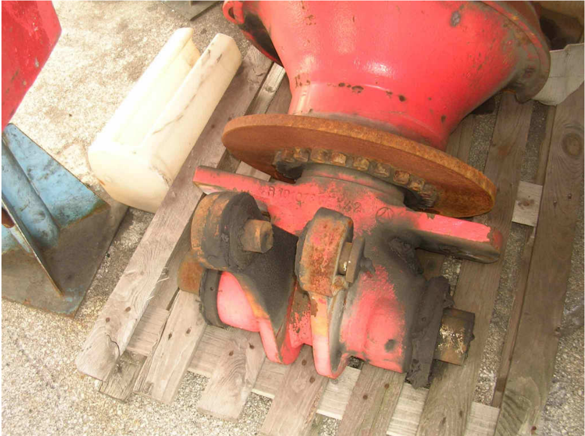
FOTO 6 – DEFORMAZIONE BLOCCO ALLOGGIAMENTO ASSE VERTICALE – N. 611
