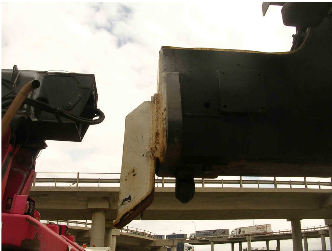
FOTO 4 – SALDATURA DI UN FLAP – N. 610
